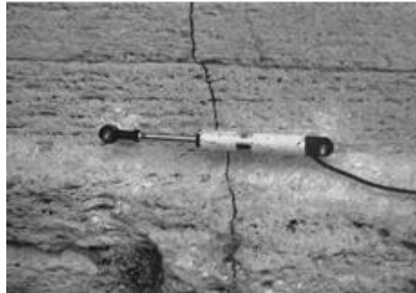
Trasduttore di spostamento, da A cura di D. Fiorani, Restauro e tecnologie in architettura , 2009.
